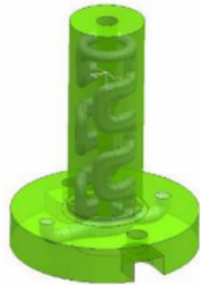
2. Sprue Bush – 3-plate mold
